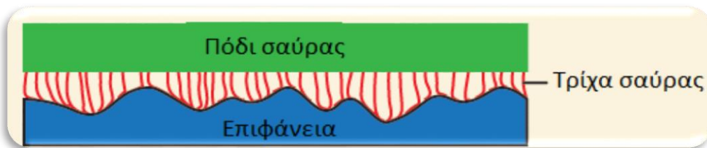
Εικόνα 17: Σκίτσο επαφής ποδιού σαύρας–επιφάνειας: Αναπαρίστανται οι τρίχες σε επαφή με τις προεξοχές μίας επιφάνειας.
