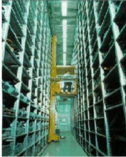
Εικόνα 9.13: Υψηλά ράφια παλέτας μεγάλου ύψους και πολύ στενών διαδρόμων
