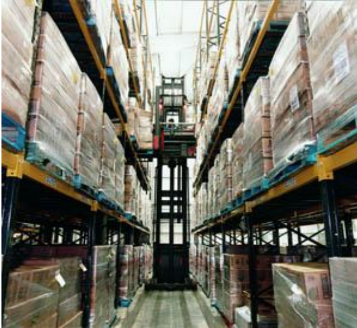
Εικόνα 9.12: Ράφια μεγάλου ύψους και στενών διαδρόμων
